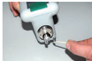
Щуповая система BFW с магнитным креплением щуповых консолей
