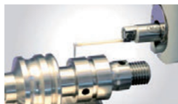
Щуповая система BFW с магнитным креплением щуповых консолей
