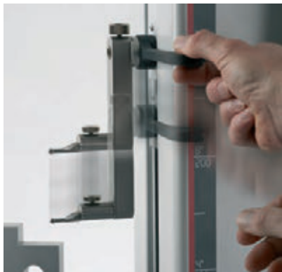
Рис. 1. Переместите измерительную каретку в направлении измеряемого объекта.
